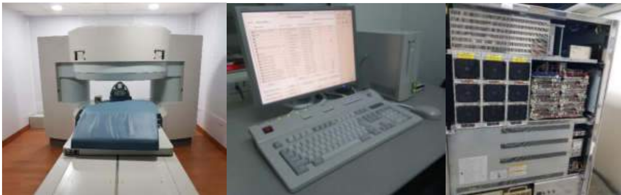
a) b) c) Figura 24. Principales componentes de un equipo de RM: a) Imán; b) consola de operación; c) Sistema de reconstrucción (cuarto de máquinas).
