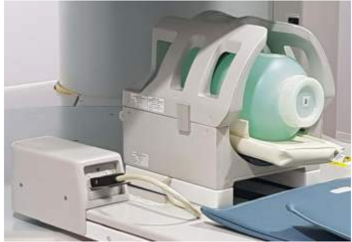
Figura 30. Disposición del fantoma y la antena de RF en el equipo para la realización de las mediciones.
