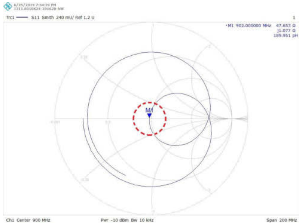
Fig. 26 Carta Smith mostrando la frecuencia de resonancia de la antena de 900 MHz.
