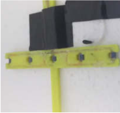
Fig. 11: Sistema de sensores de montaje superficial para temperatura, utilizados en la calibración y para el sistema de registro de temperatura interna, numerados del uno al cinco de izquierda a derecha.
