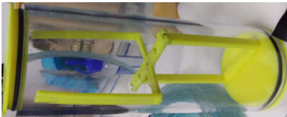
Fig. 23: Dispositivo de sostén impreso en PLA y montado en el contenedor fantoma.
