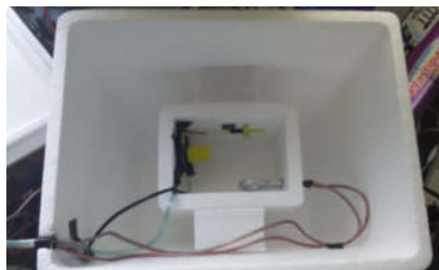
Fig. 10: estructura del sistema hermético formado por dos compartimentos de UNICEL. interior de la caja hermética.
