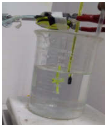
Fig. 8: procedimiento de calibrado para sistema de sensores en inmersión.
